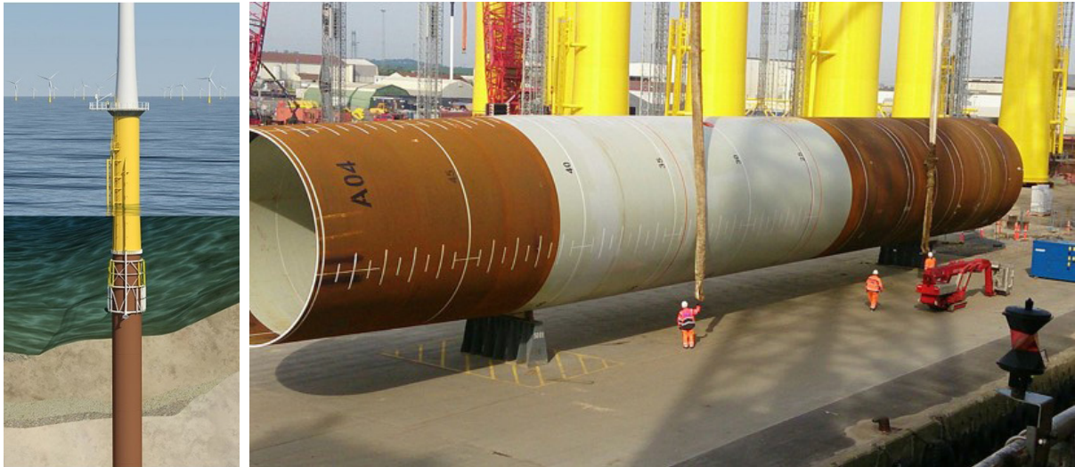
Figur 21. Till vänster: illustration av ett färdigt installerat monopilefundament. Till höger: tillverkning av monopilefundament. I bakgrunden syns färdiga övergångsstycken. Källa: COWI
