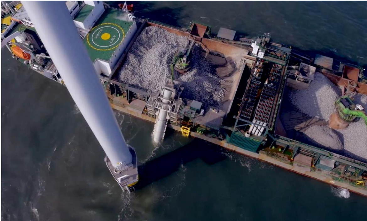
Figur 1. Exempelbild på en så kallad Fall Pipe Vessel (FPV).
